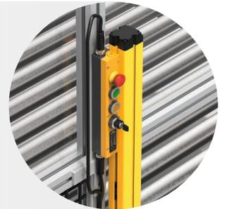
Safety Simplifier montiert am Schaltschrank des Roboters für die sichere Kommunikation und Abschaltung des Roboters.
