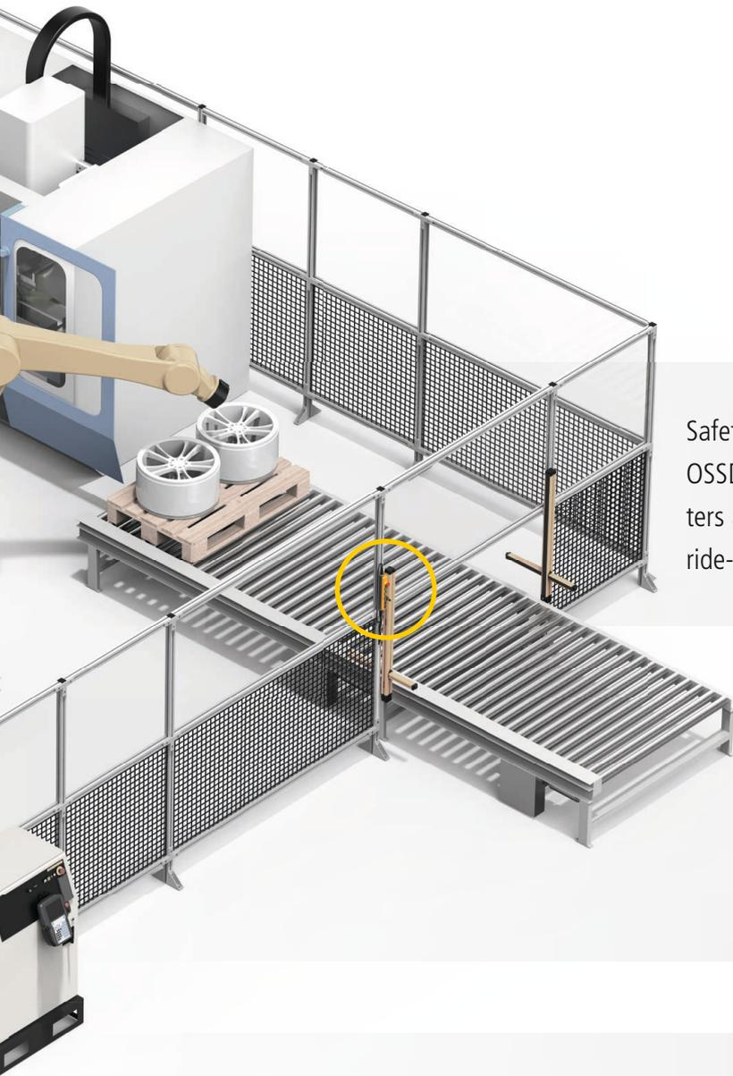
Safety Simplifier wertet die OSSD-Signale des Mutinglichtgitters aus und übernimmt die Override-Funktion bei Störungen.
