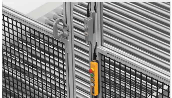
Übernimmt die Funktionen für Anforderung, Reset-Taster und Not-Halt-Funktionen. Sichere Zeiten verhindern das vorzeitige Öffnen einer Türe im Gefahrenfall.
