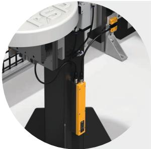
Am Werkzeugbahnhof wird der sichere Werkzeugwechsel des Roboters von Safety Simplifier überwacht.
