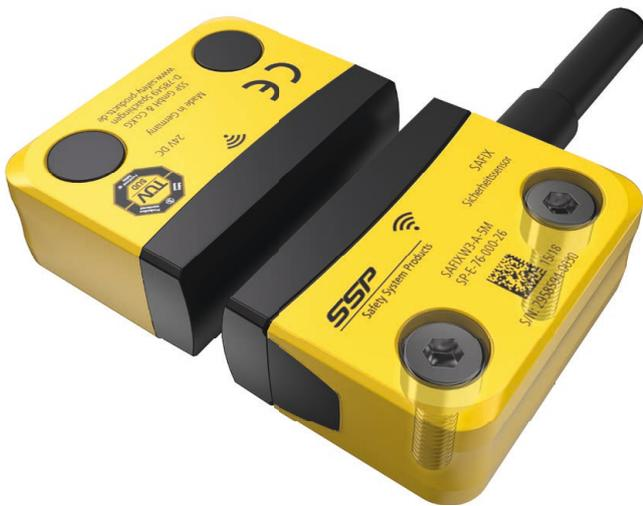
Wird in der Risikobeurteilung festgestellt, dass das Lösen des Sicherheitsschalters verhindert werden muss (EN ISO 14119), so sind die mitgelieferten Schraubenabdeckungen eine Möglichkeit auf Sicherheitsschrauben zu verzichten. Zur nachträglichen Öffnung der Schrauben, muss mit Hilfe eines speziellen Werkzeuges die Abdeckung geöffnet werden.
