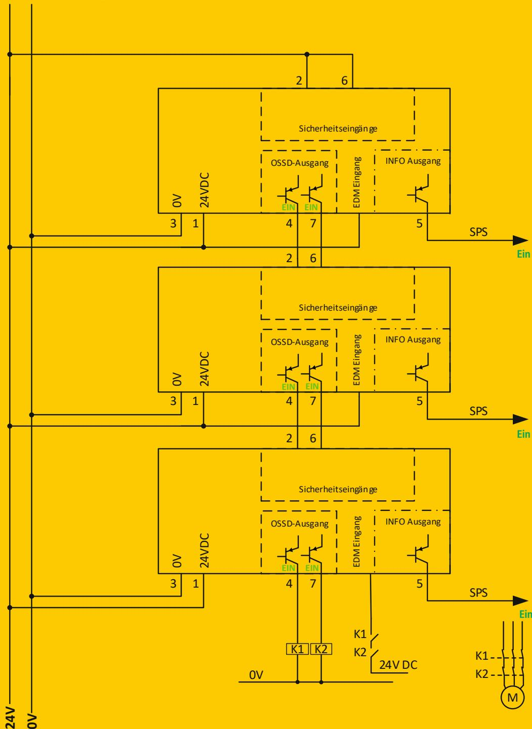
Die Eingebaute EDM Funktion übernimmt die Überwachung nachgeschalteter, zwangsführender Schütze. Ein Sicherheitsrelais ist nicht mehr nötig.
