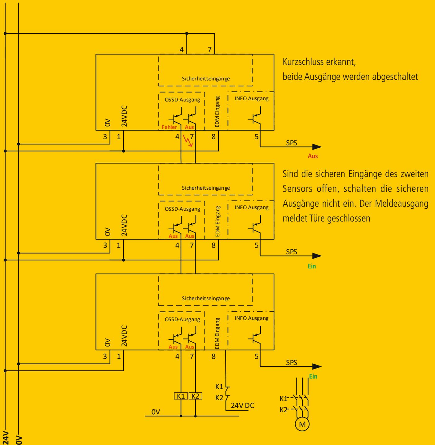
Fehlererkennung im System dank der eingebauten OSSD Ausgänge
